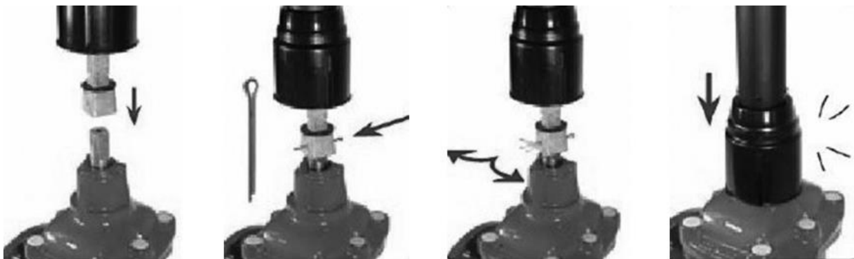
Рис. 4 Порядок установки телескопического штока на задвижку.
